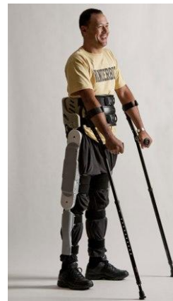
(d) Indego (actuators: 4, weight: 26 lb, cost: $80,000)
