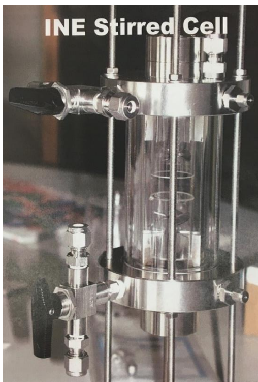
Figure 8. Institut für Nukleare Entsorgungstechnik (INE) Nitsch Cell design.
